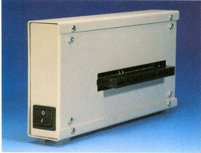
Golem Turbo 1000 Jetzt läßt sich auch der Amiga 1000 mit einem MC68030-Prozessor beschleunigen
