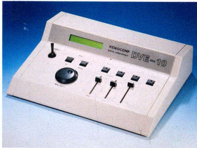
DVE-10P Das digitale Videoeffektgerät vereint Genlock (FBAS und Y/C), Digitizer (Slow-Scan) mit RGB-Splitter und Audio-/Videomischpult in einem Gerät
