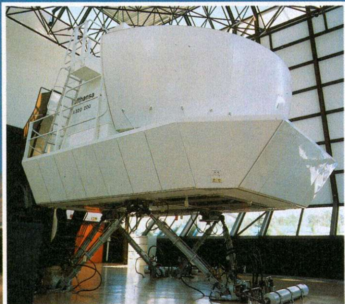
Auf und ab Pilotenkanzel auf hydraulischen Stelzen – so wird die Illusion eines Flugs perfekt
